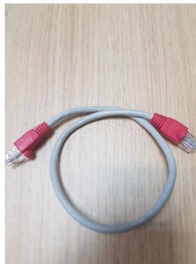
Соединительные кабели с коннекторами RJ-45. Один – от инжектора к приемнику PoE, второй – от сетевой структуры к инжектору(адаптеру). Длина кабелей – в соответствии с расстояниями между местом размещения приемника и инжектора, между розеткой 230 В и свичом PoE.
